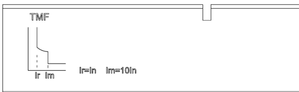
热磁固定脱扣器 (交流配电保护)
